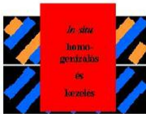
20. ábra: Talajban in situ kialakított homogén tankreaktor
