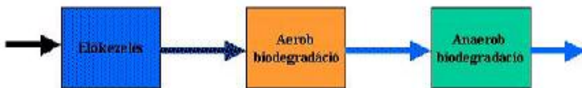
12. ábra: Kaszkádelrendezés ex situ biológiai talajvízkezeléshez
