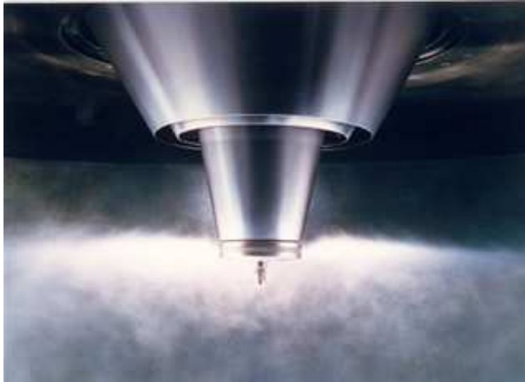
5.3.1. 3. ábra Forgótárcsás porlasztófej
