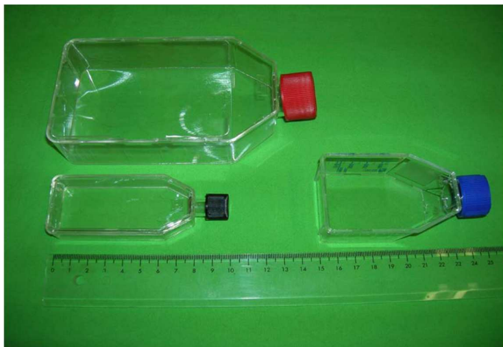
291. ábra Laboratóriumi tenyésztő edények (felületi tenyésztéshez)
