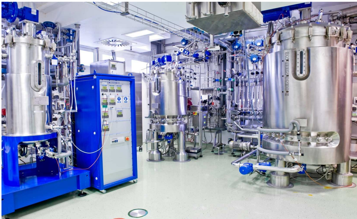
301. ábra 1 m 3 -es termelő bioreaktor (a Richter debreceni üzemében)
