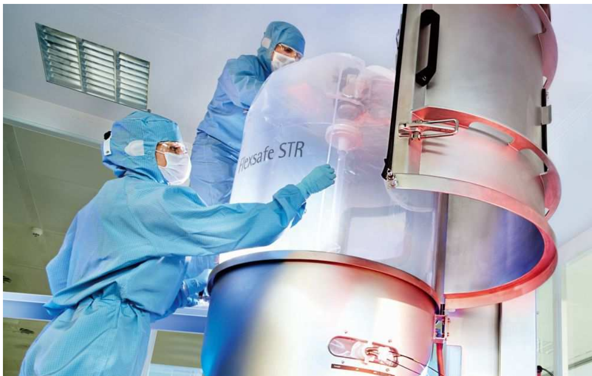
318. ábra 200 literes keverős egyszer használatos bioreaktor beállítása
