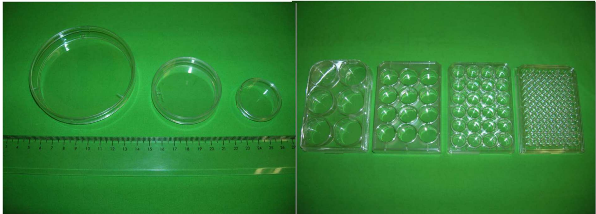
292. ábra Laboratóriumi tenyésztő edények (felületi tenyésztéshez)
