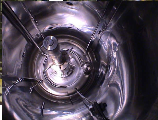
BIOSTAT 300D alsó meghajtású 300 l-es Pilot Plant fementor és keverője (B.Braun, Melsungen)
