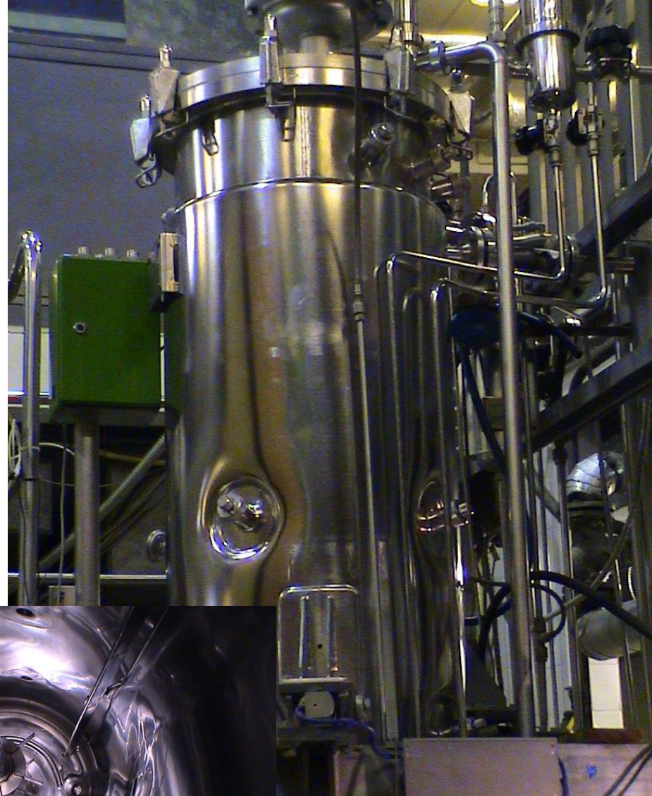
BIOSTAT 300D alsó meghajtású 300 l-es Pilot Plant fementor és keverője (B.Braun, Melsungen)
