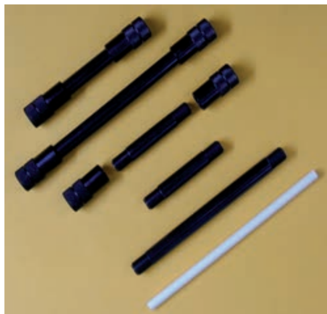
32. ábra: Szilikagél monolit rudak és a PEEK házak.
