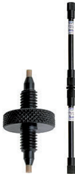
Monolit kolonnák sorba kötése
