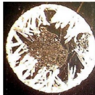
Mátrix-minta kristályok a targeten
