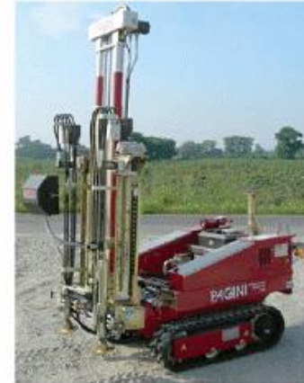
kisátmérőjű, kézi fúró (max. 12 m)
