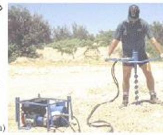
kisátmérőjű, gépi fúró (max. 25 m)
