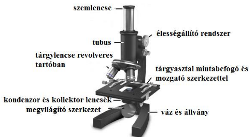
3. ábra A mikroszkóp felépítése
