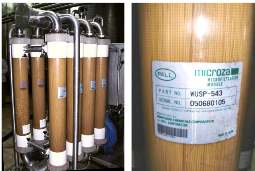
4.3.6.3.7. ábra: Nagyméretű üregesszál modulok sejtek kiszűrésére
